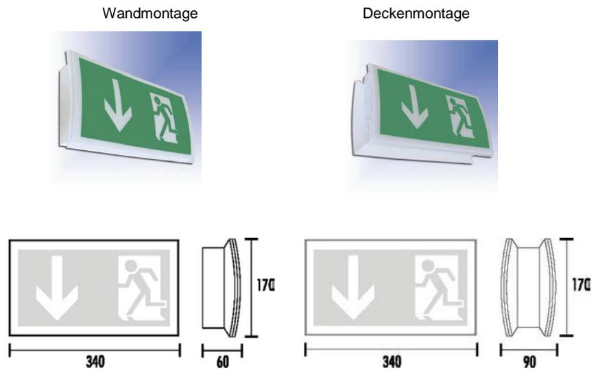
Schlanke konvexe Kunststoffleuchte nach VDE 0108 zur Kennzeichnung und Ausleuchtung der Flucht- und Rettungswege nach DIN 4844 T1+2 für ein- und zweiseitige Beschriftung. Erhältlich als EVG- oder Einzelbatterie-Leuchte gefertigt nach VDE 0711 T2-22, EN 60598-2-22 und ÖVE.
